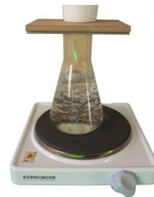
Fig. 21: Prueba de vapor de agua hirviendo
