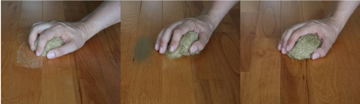
Fig. 7: Arañazos superficiales en una Superficie con un acabado UV normal
